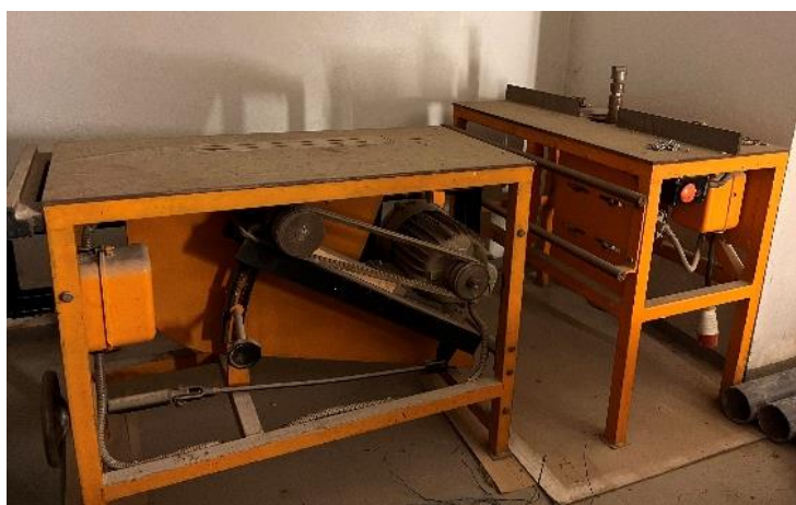
Foto 4. Esimesed tööpingid. Pildil vasakul on saag ja paremal frees.
