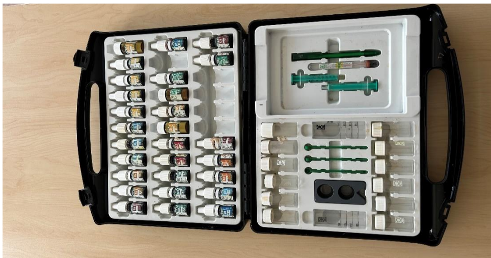
Joonis 4. Veeanalüüside komplekt JBL PRO AQUATEST. Autori foto
