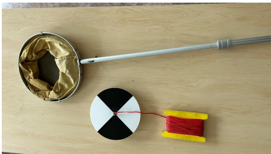
Joonis 3. Põhjakahva ja Secchi ketas. Autori foto
